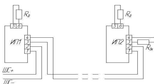
Величина  $R_d$  выбирается исходя из параметров шлейфа сигнализации, но таким образом, чтобы ток через извещатель в режиме "Пожар" не превышал 20 mA (сопротивление извещателя в режиме "Пожар" порядка 500 Ом).
